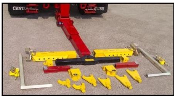
CENTURY 3212 equipo estandar con un travesaño de perfil bajo con finales desprendibles, 3 pares horquillas, base horquillas, base con gancho, y un par de bases "L", cinturones seguridad, fundas receptora bases "L" incluidas orejas de tres posiciones carga.
