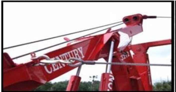
CENTURY 3212 permite que el cable sea dirigido por la carrucha de giro y enganchado a un grillete al principio de la pluma para aplicaciones de tirón laterales
