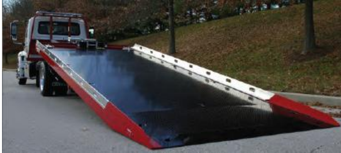
La innovadora opción de SST™ ofrece una sección sólida de inclinación que mejora el ángulo de carga de 3 1/2 grados. (opción equipo)
