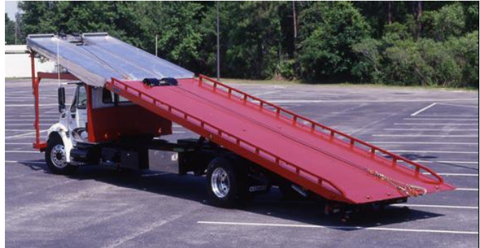
La plataforma superior de la cabina se inclina hidráulicamente para facilitar la carga y descarga.
